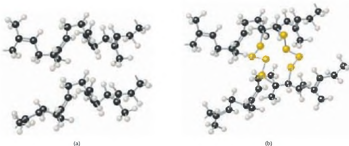
▲ Figura 12.28 Vulcanización del caucho. (a) En un caucho natural polimérico, hay enlaces dobles carbono-carbono a intervalos regulares a lo largo de la cadena, como se muestra en la ecuación 12.7. (b) Se han adicionado cadenas de cuatro átomos de azufre entre dos cadenas poliméricas por la apertura de un enlace doble carbono-carbono en cada cadena.
